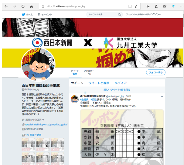
図 2 Twitter による速報の出力。試合ごとに一つの tweet として投稿される。一つの tweet には試合結果から自動生成された速報記事と星取り表が含まれる。校名にモザイク処理。
